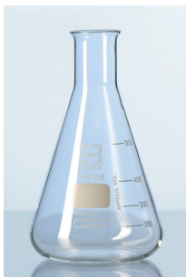
Matraz erlenmeyer en vidrio Duran®. Boca normal, graduación blanca.
