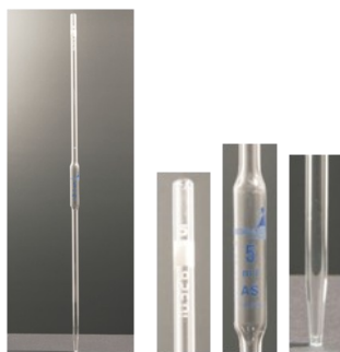
Pipeta volumétrica aforada, clase A, 1 aforo. Vidrio borosilicato, graduación ambar.
