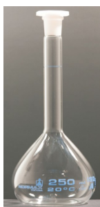
Matraz aforado en vidrio Borosilicato, clase A. Tapón polietileno, graduación azul.
