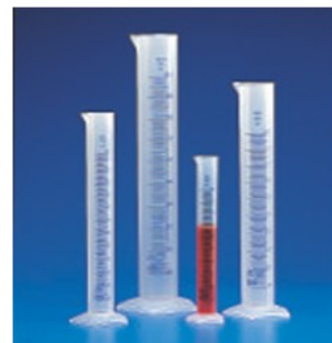
Probeta en polipropileno, clase B. Graduada en relieve.
